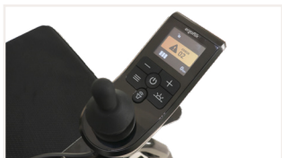
Abbildung 15: Darstellung der Störung auf dem Display
