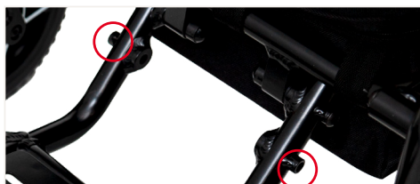
Abbildung 10: Die Schrauben an der Fußstütze
