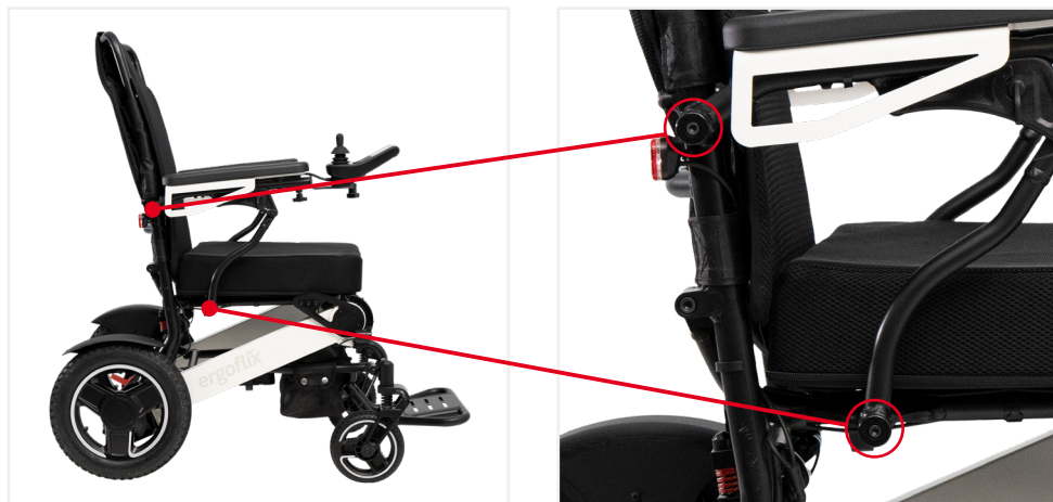
Abbildung 7: Die Schrauben an den Armlehnen
