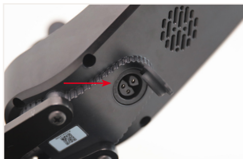
Abbildung 8: Die Anschlüsse für das Ladegerät
