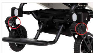
Abbildung 4: Die Federung an der Vorderradgabel des ergoflix
